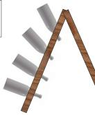
Les bouteilles sont mises sur pupitre et chaque jour les "remueurs" les font pivoter de 1/8 de tour pour faire glisser le dépôt formé par les levures mortes vers le bouchon. Petit à petit la bouteille inclinée se trouve à la verticale (sur pointe) et le dépôt est fixé sur le bouchon. Aujourd'hui se sont des machines "Gyropalettes" qui effectuent cette opération.
